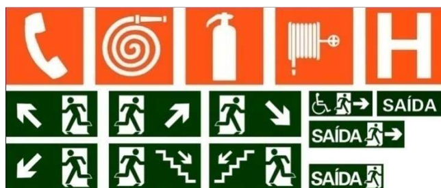
Figura 2: Exemplos de sinalização para situações de incêndio e pânico de acordo com a NBR. Fonte: ANVISA, (2002).
